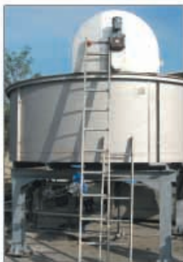
Il flottatore per il processo di chiarificazione
